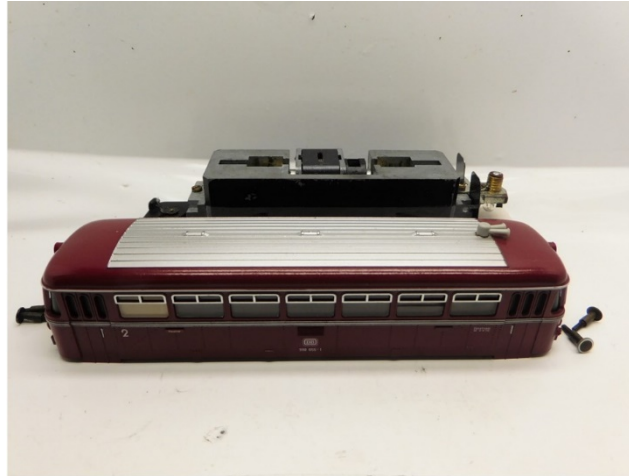
Gehäuse entfernen Remove housing Verwijder de kap
