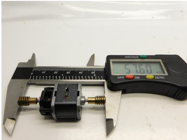
Maße prüfen Check dimensions Controleer de maatvoering
