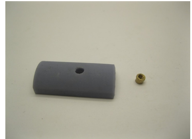
Die Messingeinsatz wird mit Sekundenkleber in den Motorhalter eingeklebt The brass insert is glued into the motor holder with superglue De messing insert wordt met secondelijm verlijmd in de motor houder
