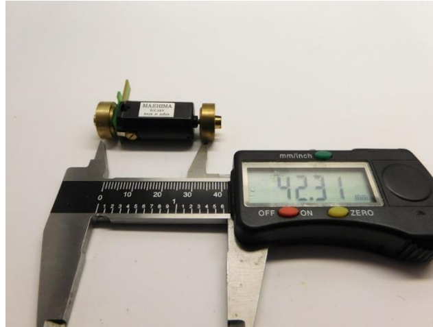
Maße prüfen Check dimensions Controleer de maatvoering
