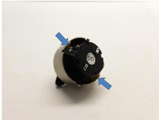
Der Motor wird mit Heizkleber geklebt The motor is glued with hotmelt De motor wordt met smeltlijm verlijmd
