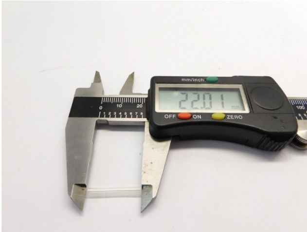
Schlauchkupplung auf Maß machen Make coupling to size Maak de koppeling op maat
