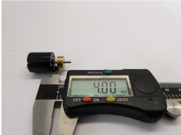
Maße prüfen Check dimensions Controleer de maatvoering
