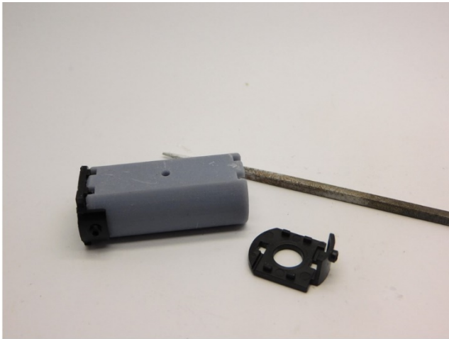
Machen Sie Platz, damit die Motorhalterung genau passt Make room so that the motor bracket fits exactly Maak ruimte zodat de motorhouder exact past
