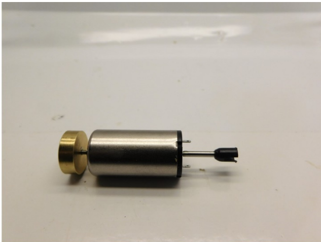
Kleben Sie die Kardankupplung mit Sekundenkleber auf den Welle Glue the cardan coupler on the shaft with superglue Lijm de kardan koppeling op de as met secondelijm
