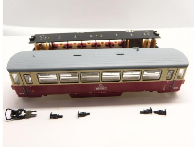
Gehäuse entfernen Remove housing Verwijder de kap
