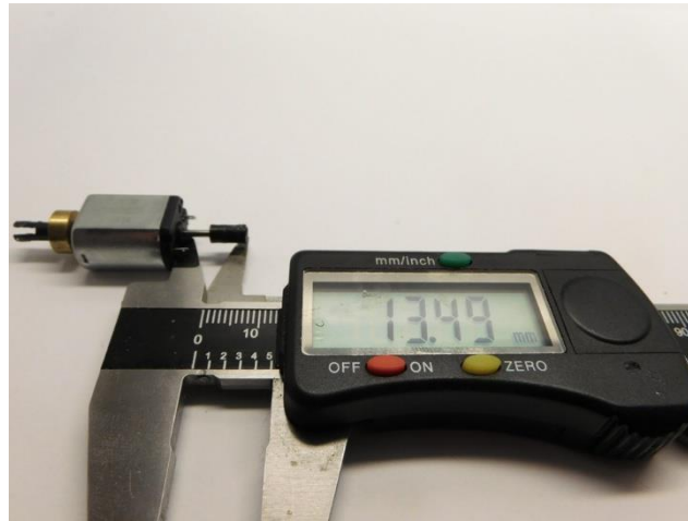
Maße prüfen Check dimensions Controleer de maatvoering
