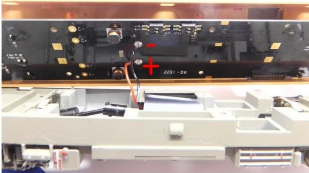
Drähte löten Solder the wires Soldeer de draden
