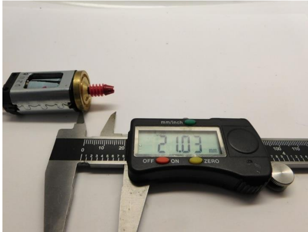
Maße prüfen Check dimensions Controleer de maatvoering
