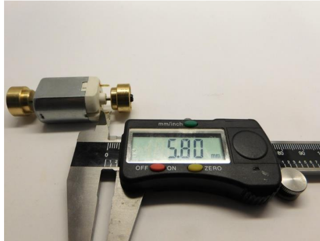
Maße prüfen Check dimensions Controleer de maatvoering
