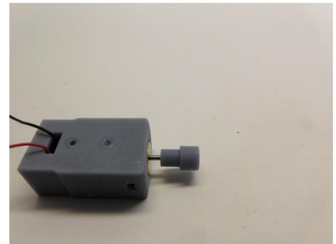
Kleben Sie die Kardankupplung Glue the cardan coupling Verlijm de cardan koppeling
