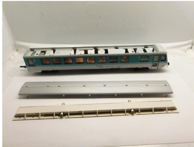
Gehäuse entfernen Remove housing Verwijder de kap
