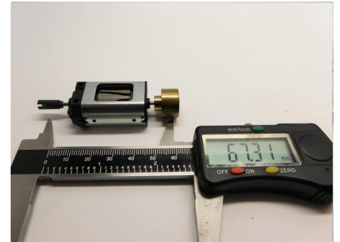
Maße prüfen Check dimensions Controleer de maatvoering
