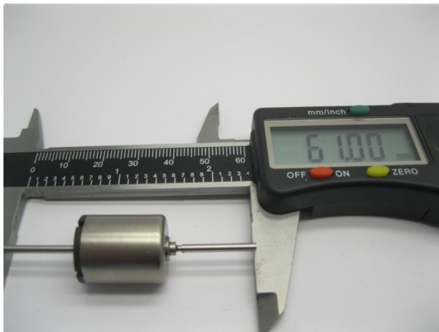
Maße prüfen Check dimensions Controleer de maatvoering
