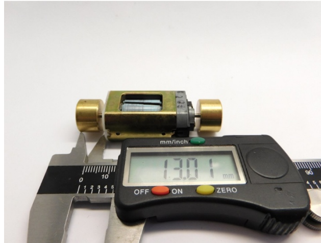
Maße prüfen Check dimensions Controleer de maatvoering
