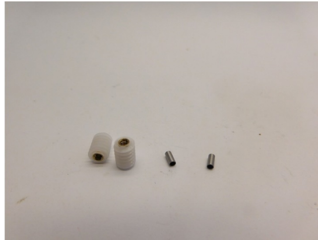
Platzieren Sie die Wellenadapter in die Schnecken Mount the shaft adapters in the worm gears Monteer de asdapters in de wormwielen
