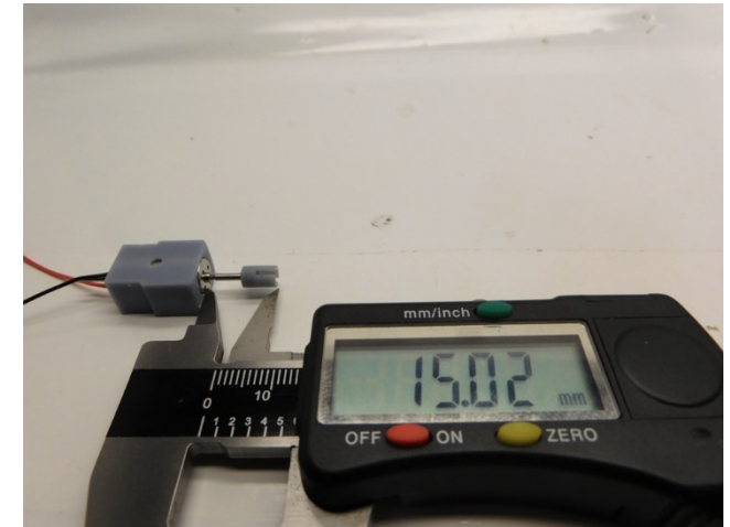
Maße prüfen Check dimensions Controleer de maatvoering
