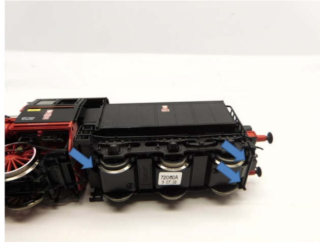
Gehäuse entfernen Remove housing Verwijder de kap
