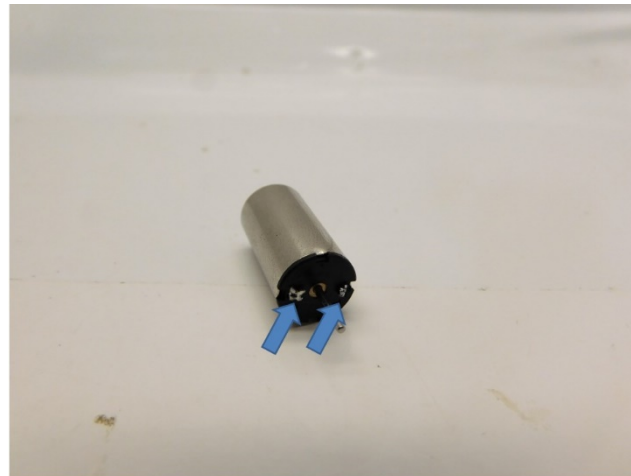
Biegen und kürzen Sie die Lötlippen! Bend and shorten the soldering lips! Buig en kort de soldeerlippen in!
