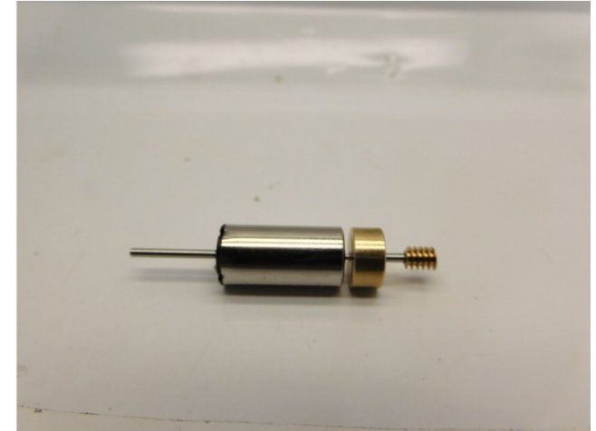
Die 1e Metallteile sind verklebt The 1st metal parts are glued De eerste metaaldelen zijn verlijmd
