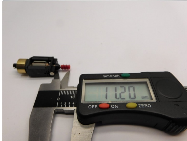
Maße prüfen Check dimensions Controleer de maatvoering
