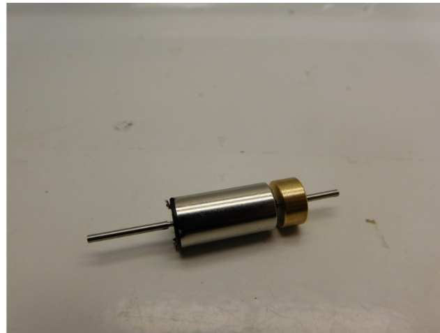
Die erste Teile sind verklebt The first parts are glued De eerste onderdelen zijn verlijmd
