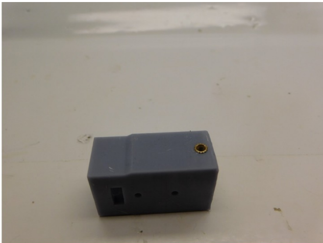
Die Messingeinsatz eingeklebt The brass insert is glued De messing insert is verlijmd
