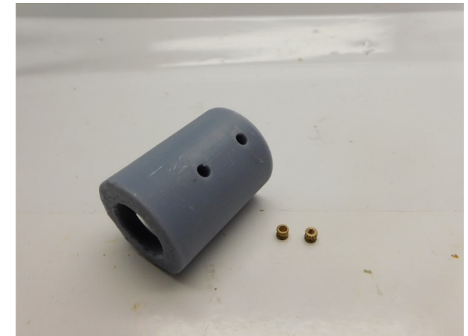
Die Messingeinsätze werden mit Sekundenkleber in den Motorhalter eingeklebt The brass inserts are glued into the motor holder with superglue De messing inserts worden met secondelijm verlijmd in de motor houder
