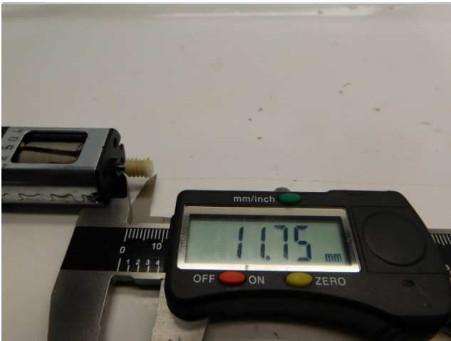
Maße prüfen Check dimensions Controleer de maatvoering
