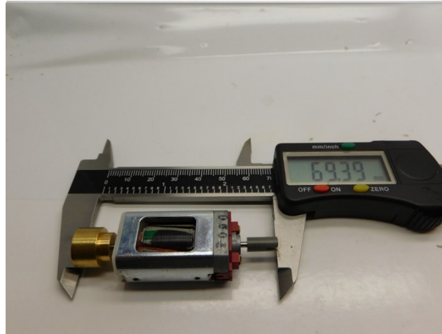
Maße prüfen Check dimensions Controleer de maatvoering
