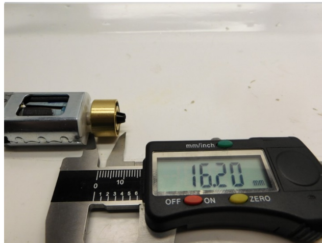
Maße prüfen Check dimensions Controleer de maatvoering
