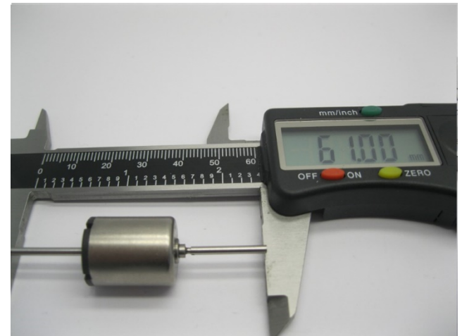
Maße prüfen Check dimensions Controleer de maatvoering
