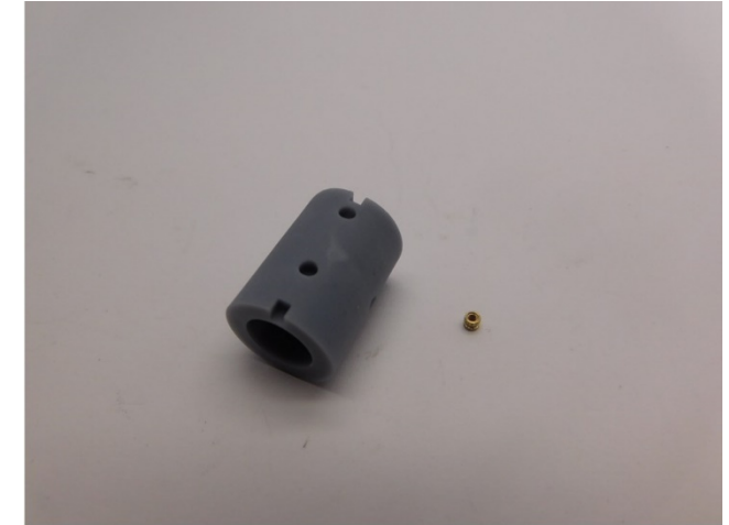
Die Messingeinsatz wird mit Sekundenkleber in den Motorhalter eingeklebt The brass insert is glued into the motor holder with superglue De messing insert wordt met secondelijm verlijmd in de motor houder
