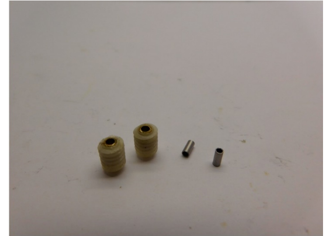
Platzieren Sie den Wellenadapter in die Schnecken Mount the shaft adapter in the worm gear Plaats de asadapters in de wormwielen
