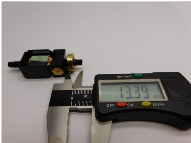
Maße prüfen Check dimensions Controleer de maatvoering
