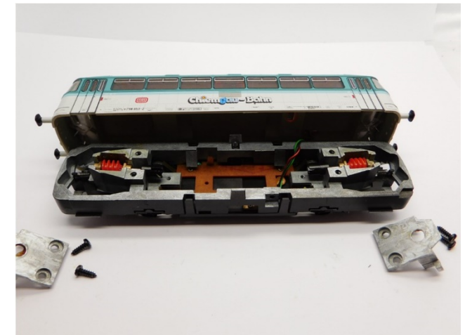
Um den Motor einfach zu montieren, demontieren wir die Kardanabdeckungen To easily assemble the motor, remove the cardan covers Om de motor eenvoudig te plaatsen demonteren we de kardan afdekplaten
