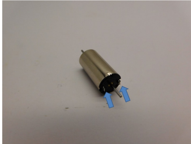
Kürzen Sie die Lötlippen! Shorten the soldering lips! Kort de soldeerlippen in!
