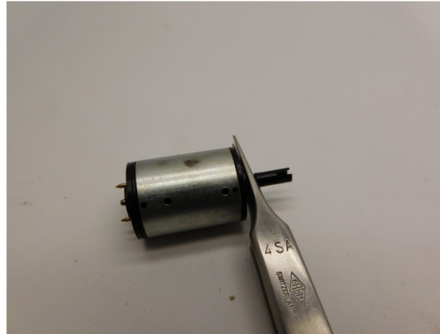
Sie brauchen dieses Teil wieder. Es wird mit einer Pinzette entfernt You need the part again. It can be removed with tweezers Je hebt dit onderdeel wederom nodig. Het kan met een pincet verwijderd worden
