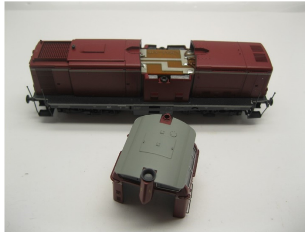
Gehäuse entfernen Remove housing Verwijder de kap
