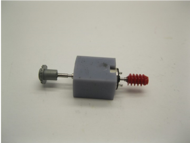
Platzieren Sie die Schnecke & Lüfter Mount the worm gear and fan Plaats het wormwiel en de ventilator
