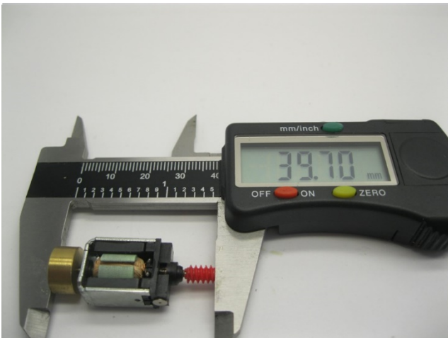
Maße prüfen Check dimensions Controleer de maatvoering
