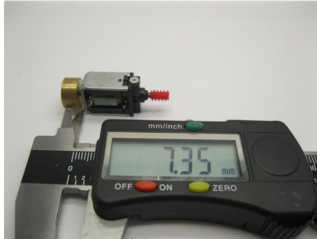
Maße prüfen Check dimensions Controleer de maatvoering
