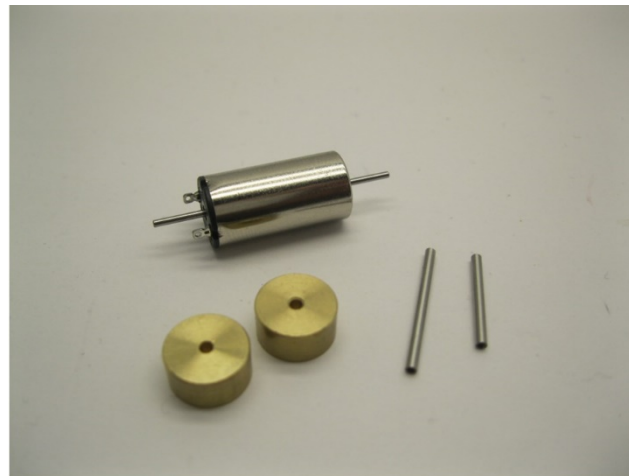
Metall Teile werden mit Loctite oder Metal Epoxy Kleber verklebt Metal parts are glued with Loctite or metal epoxy glue Metalen onderdelen worden gelijmd met metaallijm of epoxylijm voor metalen
