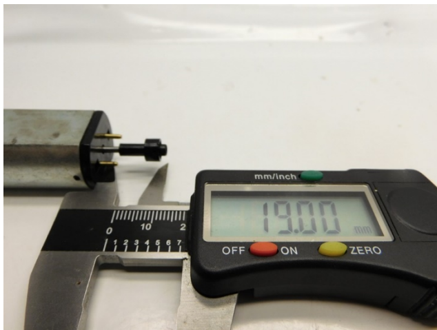
Maße prüfen Check dimensions Controleer de maatvoering
