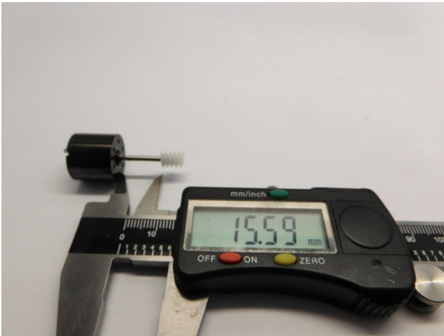
Maße prüfen Check dimensions Controleer de maatvoering
