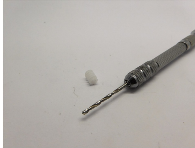
Vergrößern Sie das Loch auf 2 mm Enlarge the hole to 2 mm Vergroot het gat naar 2 mm
