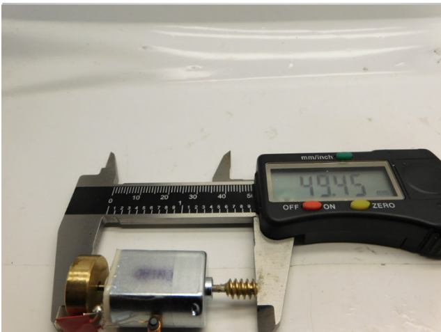
Maße prüfen Check dimensions Controleer de maatvoering
