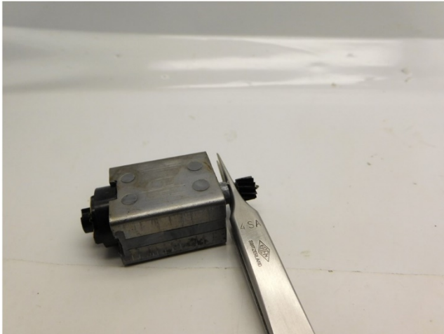
Sie brauchen dieses Teil wieder. Es wird mit einer Pinzette entfernt You need the part again. It can be removed with tweezers U heeft het onderdeel weer nodig. Het wordt met een pincet verwijderd
