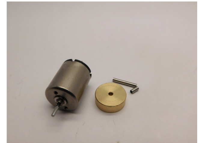
Metal Teile werden mit Loctite oder Metal Epoxy Kleber verklebt Metal parts are glued with Loctite or metal epoxy glue Metalen onderdelen worden gelijmd met metaallijm of epoxylijm voor metalen
