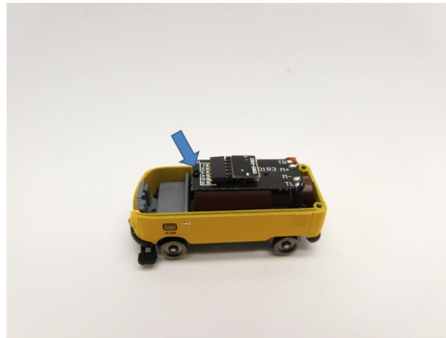
Platine entfernen Remove PCB Verwijder de printplaat
