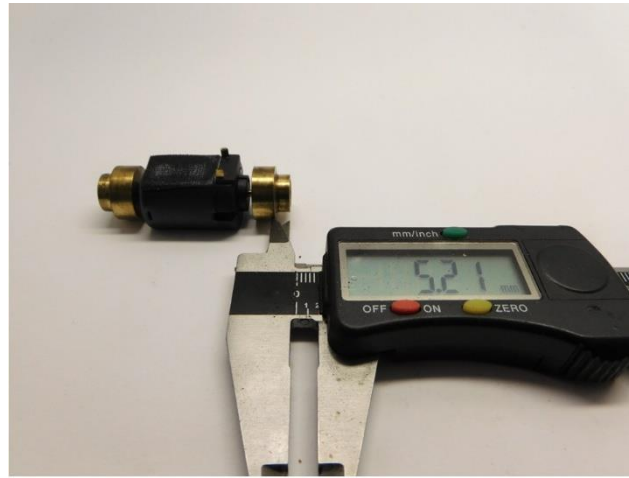
Maße prüfen Check dimensions Controleer de maatvoering
