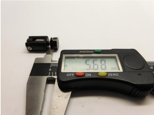
Maße prüfen Check dimensions Controleer de maatvoering
