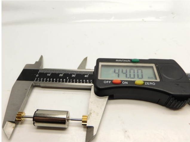
Maße prüfen Check dimensions Controleer de maatvoering
