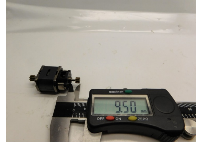
Maße prüfen Check dimensions Controleer de maatvoering
