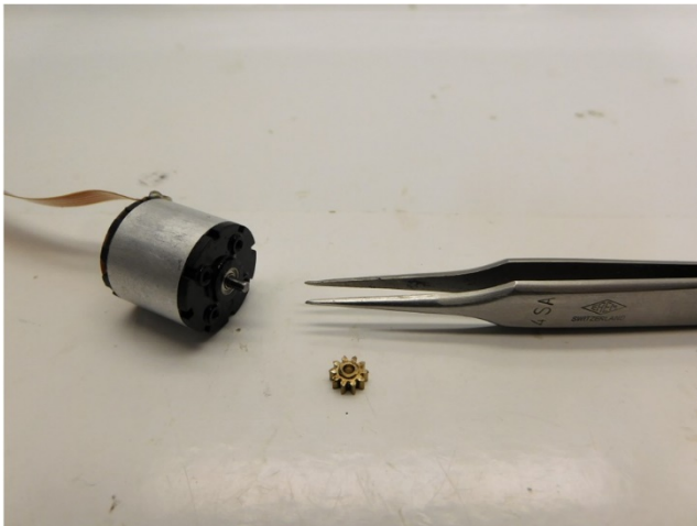
Sie brauchen dieses Teil wieder. Diese wird mit einer Pinzette entfernt You need the part again. It can be removed with tweezers Je hebt dit onderdeel wederom nodig. Het wordt megeen pincet verwijderd
