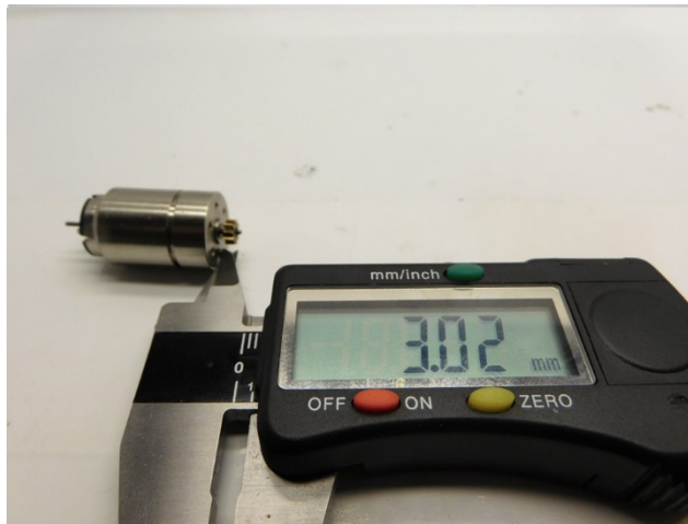
Maße prüfen Check dimensions Controleer de maatvoering
