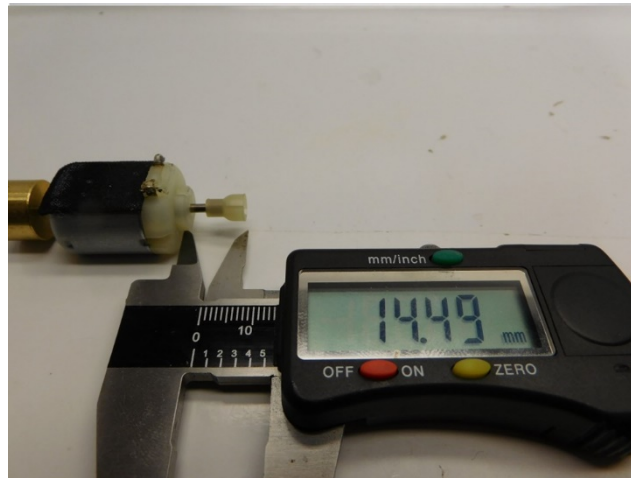
Maße prüfen Check dimensions Controleer de maatvoering
