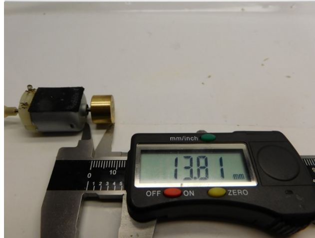
Maße prüfen Check dimensions Controleer de maatvoering
