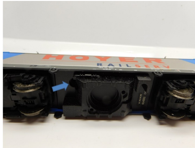
Gehäuse entfernen Remove housing Verwijder de kap
