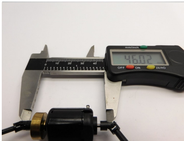
Maße prüfen Check dimensions Controleer de maatvoering
