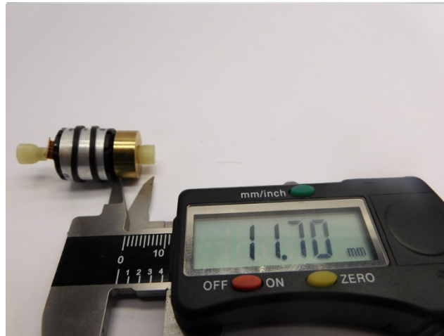
Maße prüfen Check dimensions Controleer de maatvoering
