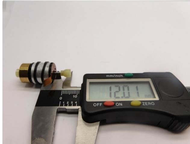
Maße prüfen Check dimensions Controleer de maatvoering
