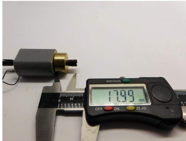
Maße prüfen Check dimensions Controleer de maatvoering
