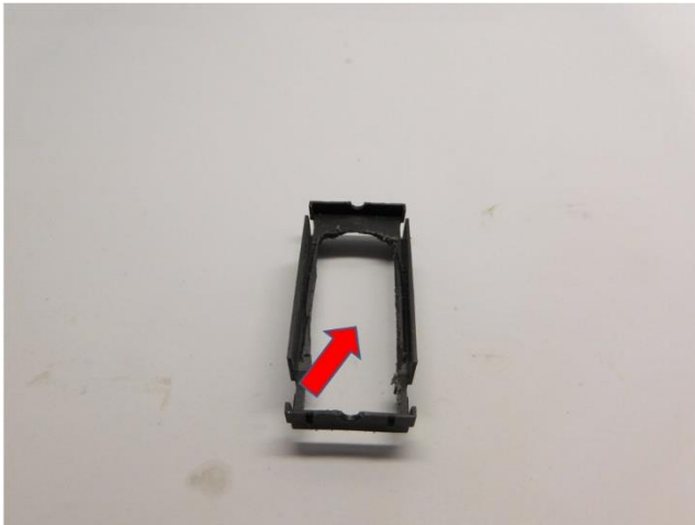
Mit einer Trennscheibe ein Teil aus der Motorhalterung schleifen Take out a part of the motor holder with a cutting disk Verwijder een deel uit de motorhouder met de slijpschijf
