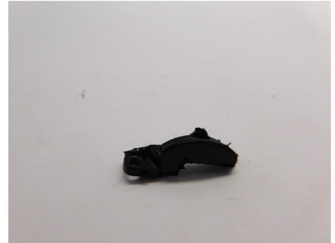
Mit einer Trennscheibe ein Teil aus der Motorhalterung schleifen Take out a part of the motor holder with a cutting disk Slijp met de slijpschijf een deel uit de motorhouder
