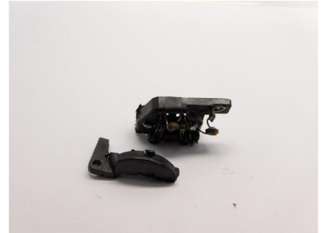
Mit einer Trennscheibe ein Teil aus der Motorhalterung schleifen Take out a part of the motor holder with a cutting disk Slijp met de slijpschijf een deel uit de motorhouder
