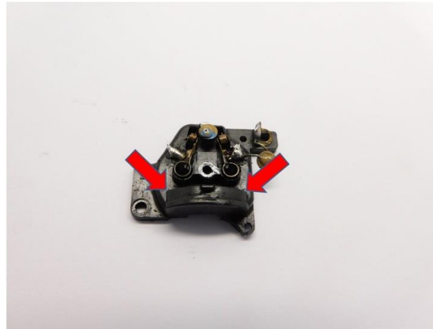
Mit einer Trennscheibe ein Teil aus der Motorhalterung schleifen Take out a part of the motor holder with a cutting disk Slijp met de slijpschijf een deel uit de motorhouder
