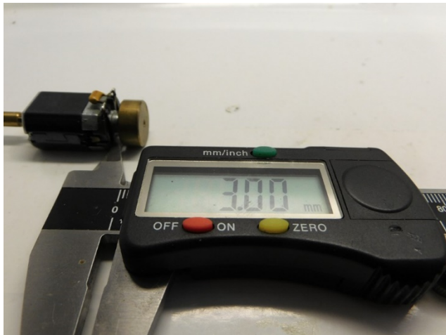
Maße prüfen Check dimensions Controleer de maatvoering
